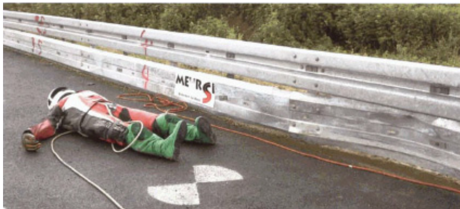
Bild 5: Eco-Safe MPS (C60 - II) geprüft nach Teil 8 von DIN EN 1317
