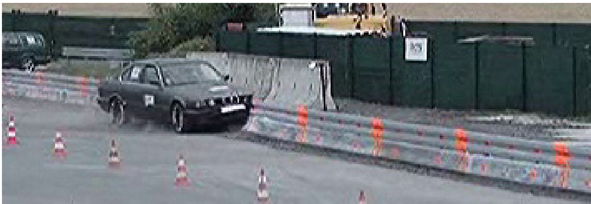
Bild 3: Eco-Safe MPS (N2-W3-A) – Prüfung nach Teil 2 von DIN EN 1317
