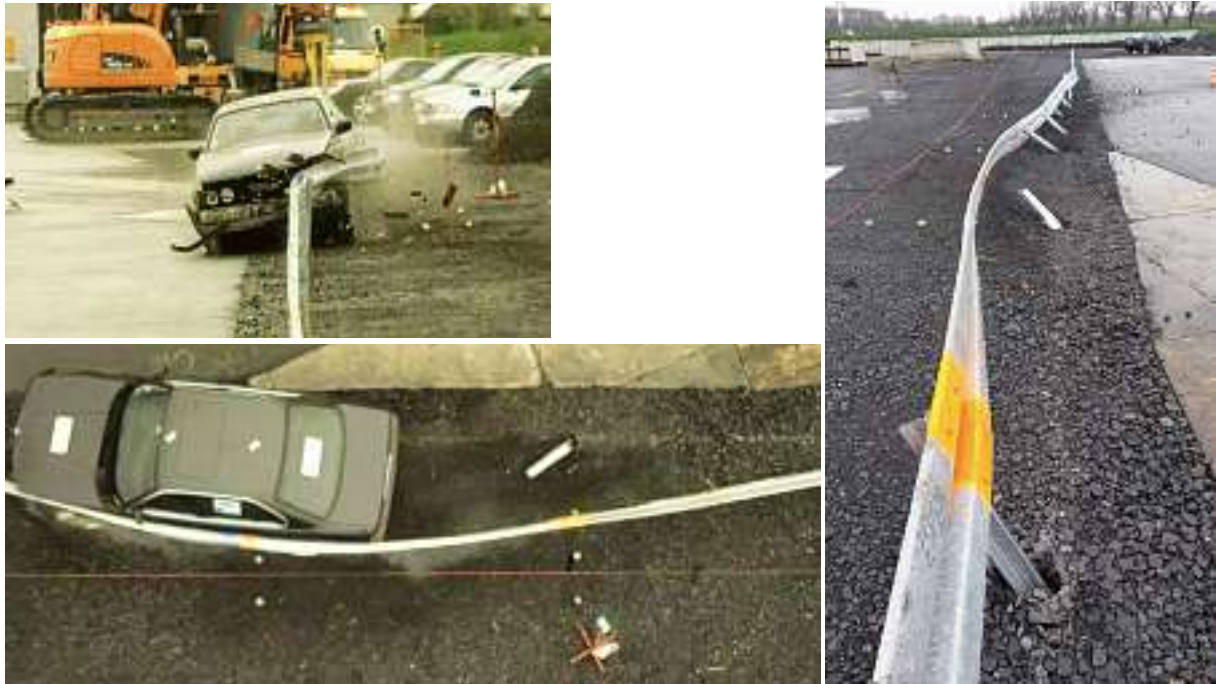
Bild 2: Fotos von der TB32-Prüfung an Flextra ESP – Eco-Safe
