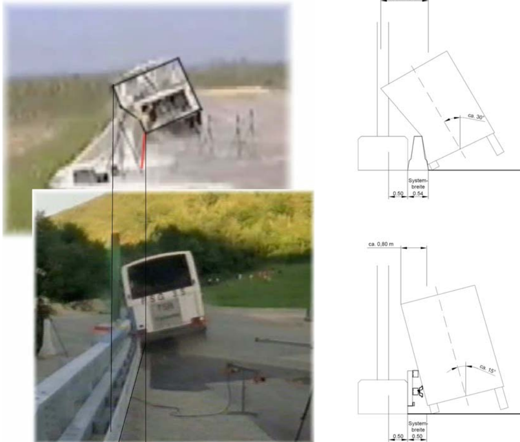
Bild 1: Vergleich der maximalen seitlichen Fahrzeugposition beim Anprall eines 13 t Busses
