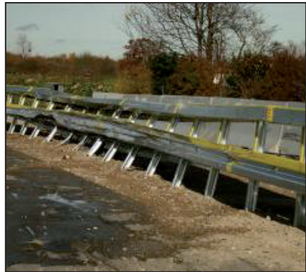
Bild 6: Schaden nach der Anprallprüfung TB81
