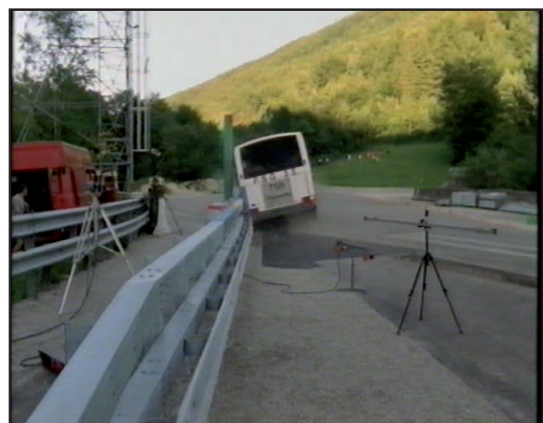
Bild 4: Anprallprüfung an SR VZB
