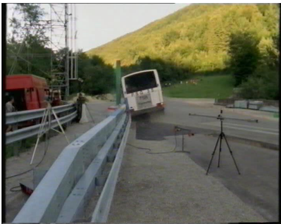
Umlenkvorgang mit einer Super-Rail VZB
