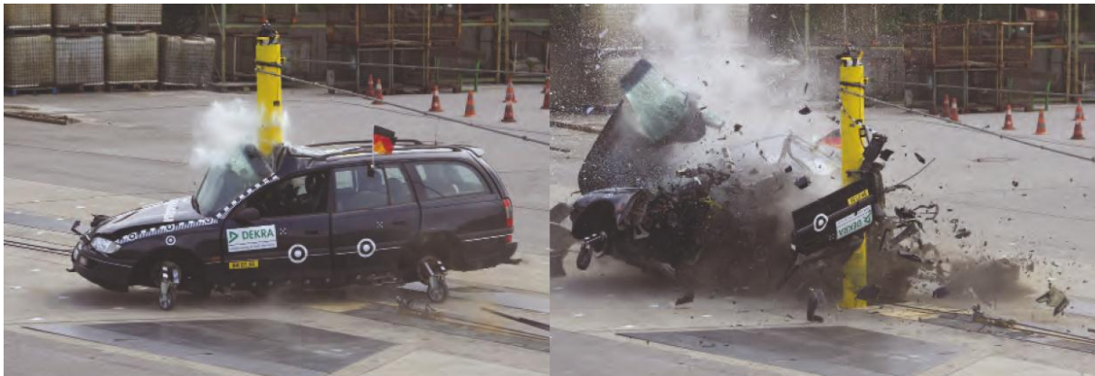
Anprall mit 97 km/h unter einem Winkel von 23°
