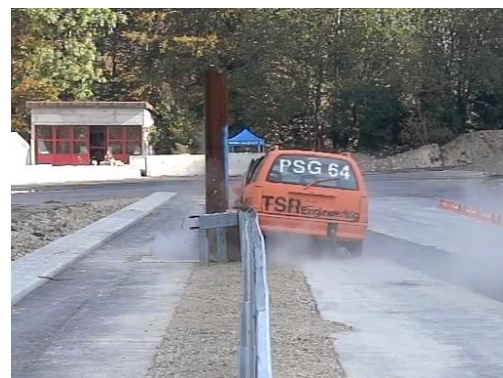
Anprallprüfung an einer ESP-BOS
